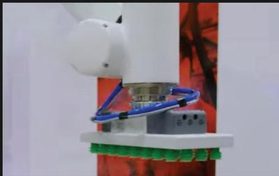
Gripper multiformato de fácil reemplazo.
